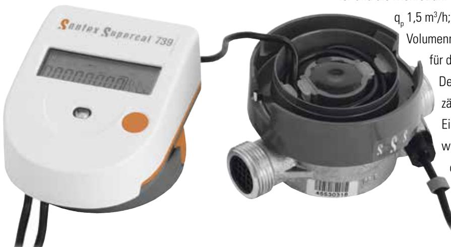
Der Kompakt-Wärmezähler **Supercal 739** ist verfügbar als Einstrahlzähler und als Mehrstrahl-Messkapselzähler für die Durchflüsse  $q_p$  0,6 m<sup>3</sup>/h;  $q_p$  1,5 m<sup>3</sup>/h;  $q_p$  2,5 m<sup>3</sup>/h. Das Rechenwerk ist trennbar vom Volumenmessteil und bietet so eine optimale Flexibilität für den Einbau.
